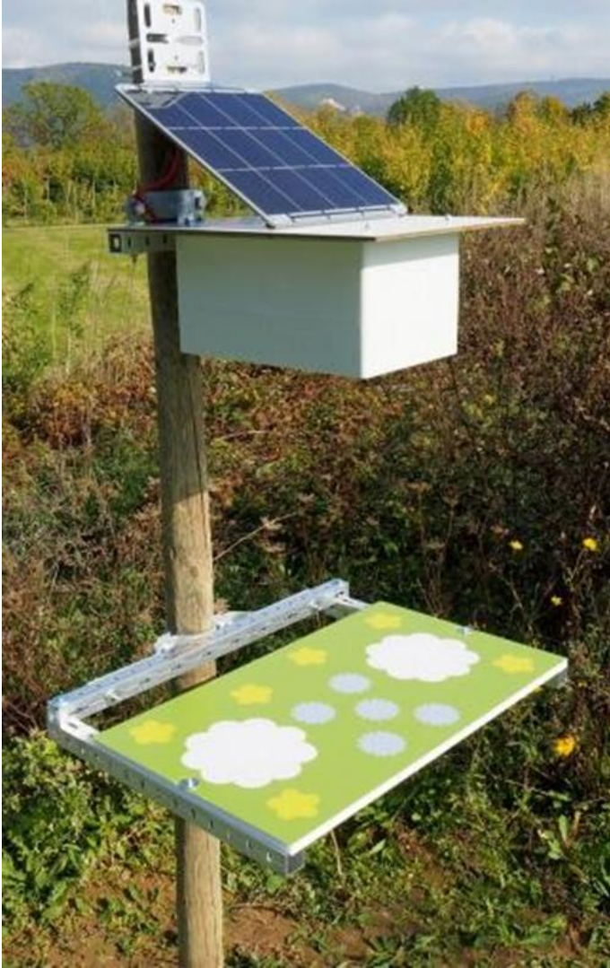
基于人工智能的昆虫探测摄像诱捕器，用于连续自动探测所研究地块上的访花昆虫。农业用地多样性监测项目（MonViA）就使用该设备进行监测。
